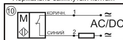
Схема подключения Нормально-замкнутый контакт
